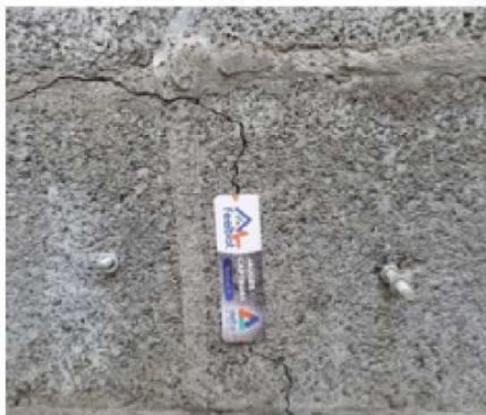
Positionnez les ancrages du capteur de part et d'autre de la fissure, l'espacement conseillé à l'axe des points d'encrages est de 16 cm ( attention à bien vérifier car cette valeur peut légèrement diffère selon le pack de connexion choisie )
