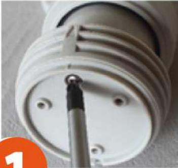
Retirez la vis de blocage, vous constaterez une collerette d'étanchéité à ne surtout pas perdre et replacer sur la vis.
