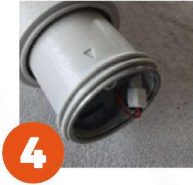
À présent, votre capteur émet un signal Bluetooth, vous devez le connecter à votre compte pour le rendre inaccessible aux autres comptes, rangez la pile au fond et bloquez le connecteur dans le creux.
