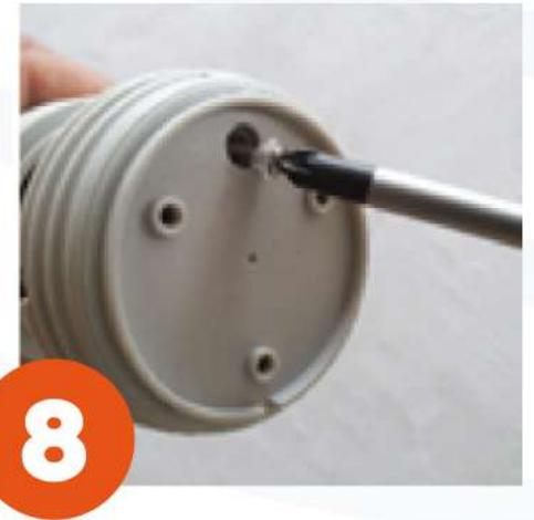
Remplacez la plaque de liaison en plaçant bien le détrompeur, fixez le système avec les trois vis sans forcer le pas de vis, assurez-vous du bon contact du bloc avec le bouchon, vissez les vis 1/3 par 1/3
