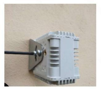
Glissez le capteur dans l'équerre en vérifiant que le coter ou il est marquée "onde radio ne pas ouvrir" soit vers le haut.
