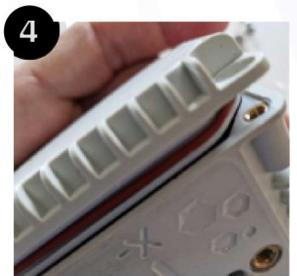
REPLACER LE COUVERCLE DU DELTA R ET PRENDRE SOIN DE BIEN VÉRIFIER QUE LE JOINS TORIQUE EST BIEN POSITIONNÉ POUR BIEN REFERMER LE COUVERCLE DU DELTA R
